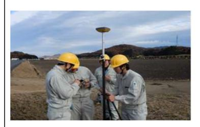
GPSにより標定点を測量している様子
